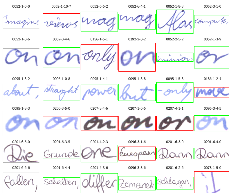
Fig. 8: 使用 ResNet20 + NetVLAD 对 CVL 数据集进行单词检索的定性结果。左侧图像是查询图像，后面是五个最相似的单词 (ID: Writer-Page-Line-Word)。
