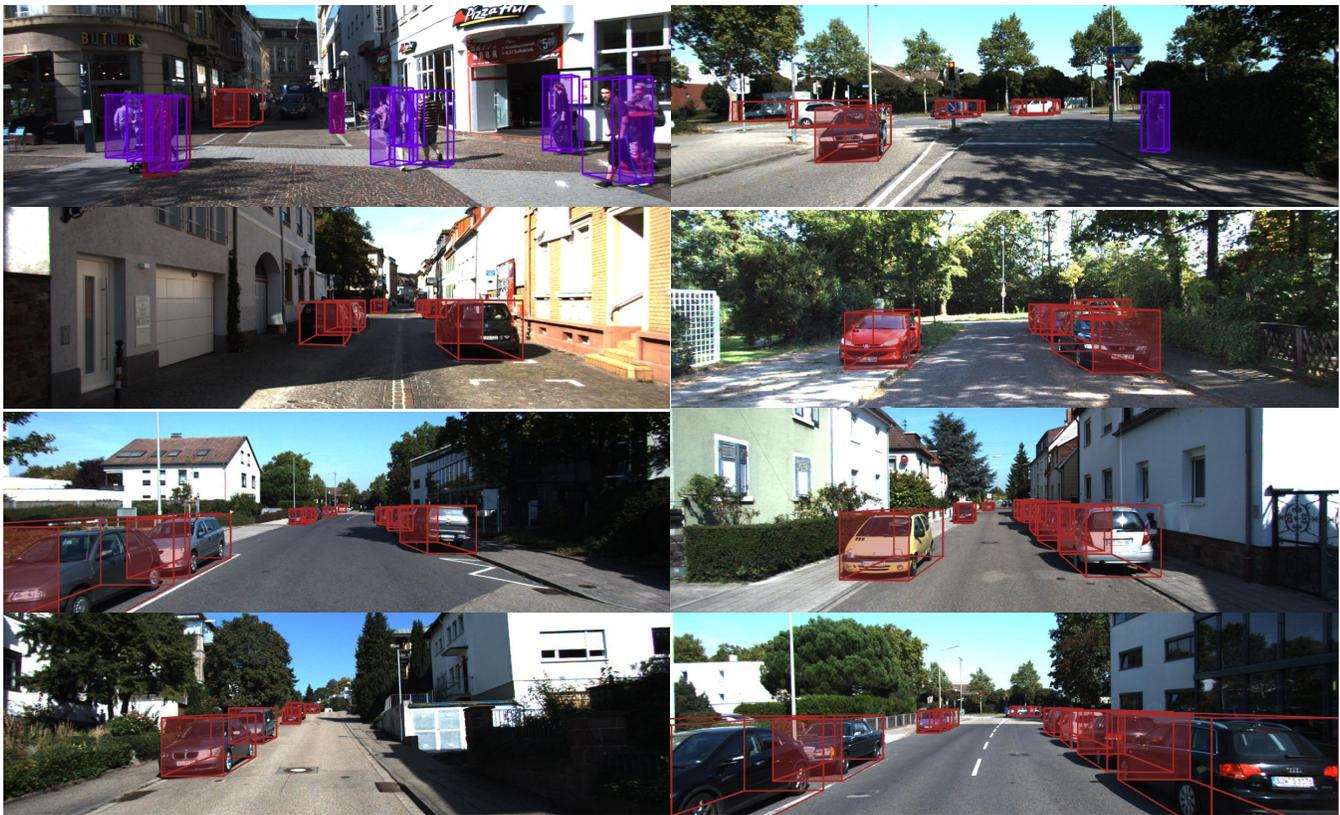
Fig. 4: 单目 3D 物体检测在 KITTI 数据集上的可视化结果清晰直观地展示了检测算法在识别和定位数据集中复杂道路场景中的 3D 物体时的性能和准确性。
