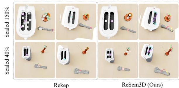
Fig. 7. ReKep 和 ReSem3D（我们的方法）在约束建模中的比较。每种方法有两列，分别展示 RGB 和点云的可视化效果，两行分别对应 150% 和 40% 对象尺度。紫色、绿色和红色的数字标签分别表示 MLLM 在烤面包机、花瓶和杵上提取的初始 2D 约束，而彩色箭头表示几何和位置 3D 约束的细化。
