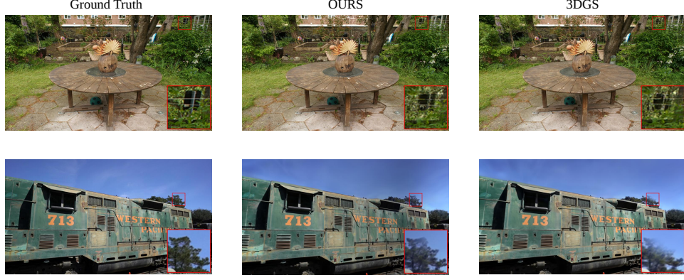
Fig. 1: 渲染图像与真实图像之间的区别。与第一行的图像相比，3DGS 渲染的窗户失去了其几何形状，边缘变得不清晰。第二行图像的比较显示，3DGS 的渲染结果缺失了一些内容。
