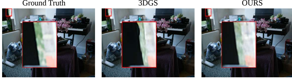
Fig. 5: 3DGS 边界区域重建误差，将重建的直线边界视为曲线边界。3DGS 对边界信息没有有效的约束，这导致对边界重建的关注不足，使得准确重建边界变得困难。
