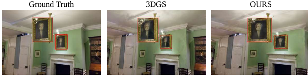
Fig. 3: 在普通的 3DGS 中观察到细节不足和模糊问题。特别是，渲染场景中的吊灯和框架显示出明显的失真和模糊，包括弯曲的墙面和边缘。这些伪像表明 3DGS 在处理锯齿边缘和边界时存在困难，同时难以保持整体场景几何形状，导致最终图像出现失真和模糊。
