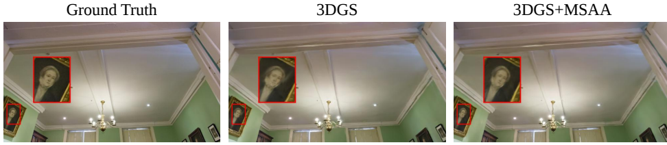
Fig. 10: MSAA 消融实验的结果。3DGS 在重建和渲染肖像时生成了一些不存在的部分，降低了渲染结果的清晰度。加入 MSAA 方法后，我们在重建和渲染过程中有效地区分了肖像、空白空间和边框的区域，使每部分的内容更清晰。
