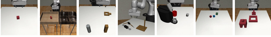
Figure 2: RoboMimic（提起、罐子、方块和工具挂）和 MimicGen（咖啡、堆叠和组装）任务被考虑用于 KDPE 的评估。
