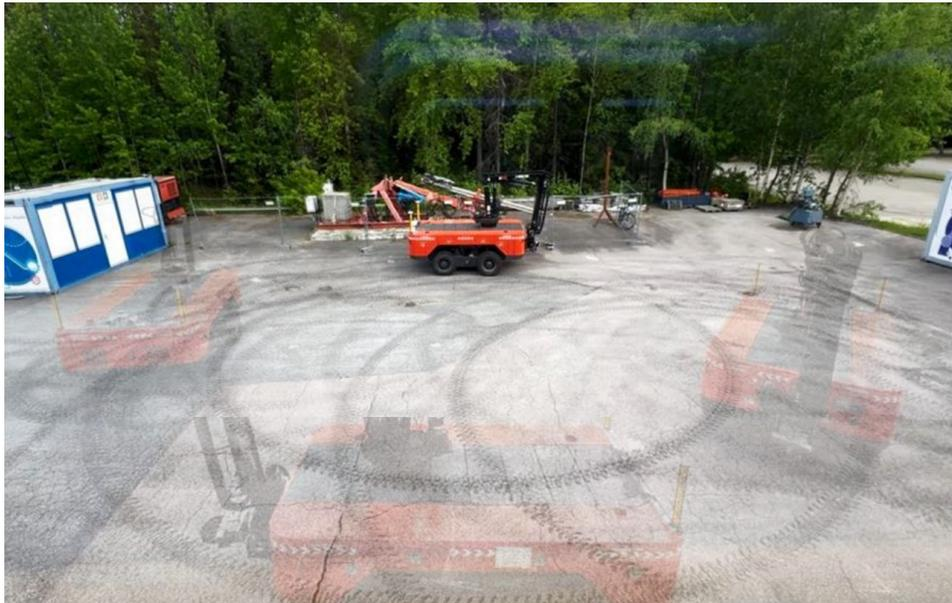
Fig. 5: 6000 公斤 SSWMR 在一个安全层下使用 LM 训练的 DNN 控制策略（实验 1）和安全 RAC 策略（实验 2）跟踪的圆形轨迹（6 米半径）。
