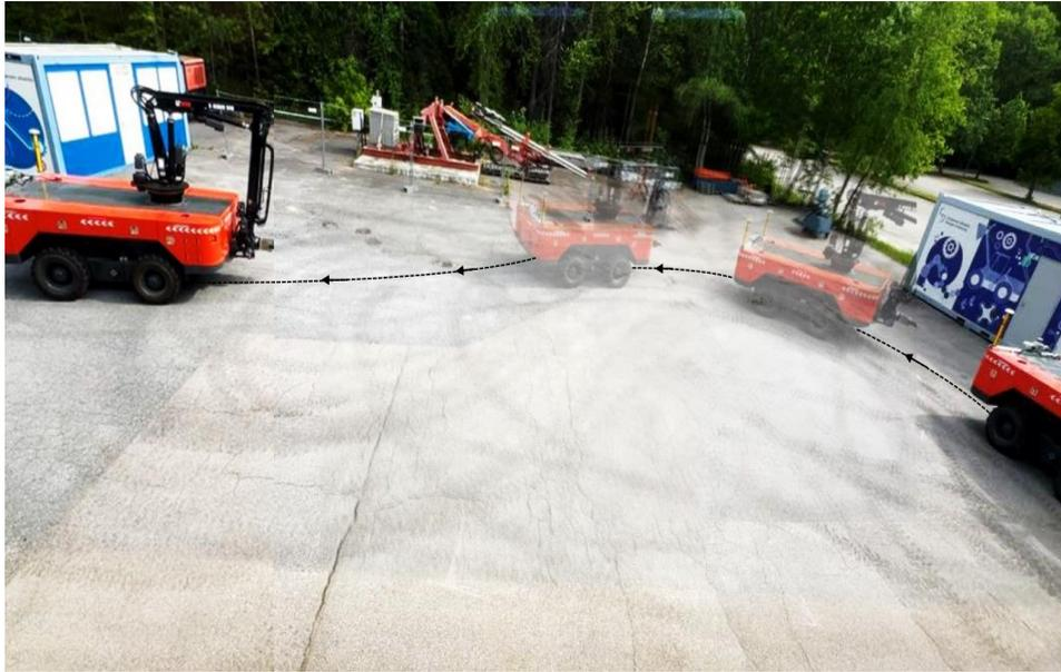
Fig. 24: 实验 3: S 形轨迹由 SSWMR 跟踪, 该过程使用 LM 训练的 DNN 的综合和在两个安全层下的安全 RAC 策略。
