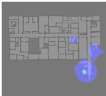
Fig. 1: 并非所有的前沿区域对探索来说都同样重要；有些可以导致完成房间内的局部探索，而其他则可以将机器人引导到建筑物的完全不同部分。我们将显著区域识别为对探索有高度兴趣的区域，并用浅蓝色标出，并将这一理念整合到不同的探索策略中。
