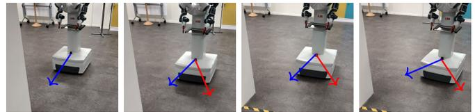
Figure 6. 移动-YuMi 研究平台的障碍回避顺序。机器人移动到障碍物后面的一个位置，寻找能使其远离障碍物的路径。蓝色箭头显示基础在仅执行 IK 任务时将采取的行为，红色箭头显示应用的整体控制，包括障碍回避任务。请注意，如果没有障碍回避任务，机器人将会撞到障碍物。
