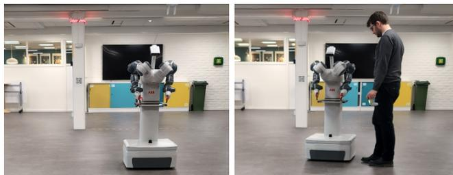
Figure 10. 移动式 YuMi 研究平台在环境中导航时远离人类操作员。左侧显示它在实验室中达到期望的姿态，然后它移开，右图显示了它避开与用户碰撞的场景，在模拟中它学会了优先考虑安全，即使这意味着可能错过目标。
